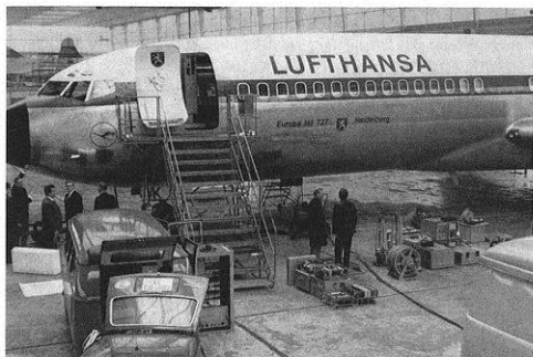
Bild 1 Nur beschränkter Raum stand in der Boeing 727 für die umfangreiche Fernseh-ausrüstung, darunter dem Fernsehkanal-Meßsender SBTf von Rohde & Schwarz, zur Verfügung.
