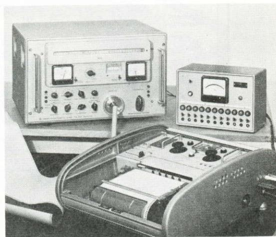
**Bild 4** Frequenzbandüberwachung mit dem Empfänger EK 07 und dem Registriergerät der Fa. Huber. Das Zusatzgerät rechts im Bild erlaubt, beim automatischen Absuchen eines Bereiches die Regelspannung des Empfängers in 10 Stufen umzuschalten, so daß neben der Frequenzregistrierung auch eine Amplitudenbewertung erfolgt. 8080
