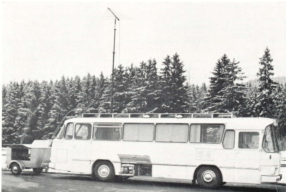
Bild 1 Meßfahrzeug (Magirus 150 L 10) für den Österreichischen Rundfunk. Die Hauptstromversorgung, ein 10-kVA-Generator, ist im Anhänger untergebracht. Das geöffnete Fach im Fahrzeug selbst enthält das 1-kVA-Notstromaggregat. Foto 18 516
