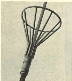
Bild 7 Sprühschutzkorb zur Verhinderung von Sprühscheinungen an der Stoßstelle Abspannspirale-Polyesterstab. Korbdurchmesser etwa 15 cm. Foto 14 673
