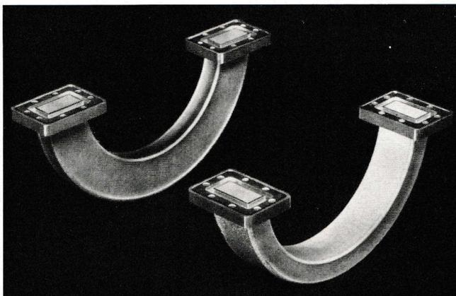
Bild 1: Links H-Krümmen, rechts E-Krümmen für 7,5 GHz, Innenabmessung  $34,85 \times 15,80 \pm 0,04$  mm, auf wiederverwendbarem Kunststoffkern hergestellt. Flansche nach Außenbearbeitung des Rohrendes hart angelötet.
